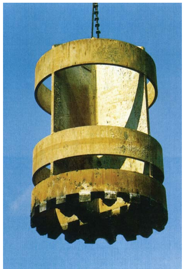
Meißel Typ B für harten Fels Trépan type B pour roche dure Chisel type B for hard rock
