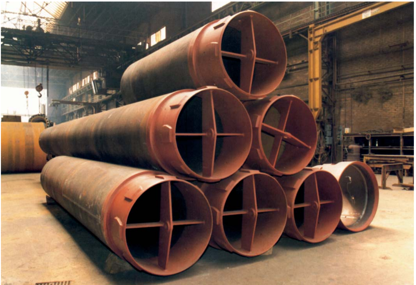
Abschalrohre 1000 mm \varnothing vor dem Versand
