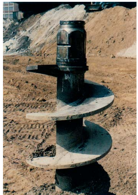
Endlosschnecke 600 mm \varnothing mit Verbindungselement Vis sans fin de 600 mm de avec element de liason Continuous flight auger 600 mm dia. with connecting element
